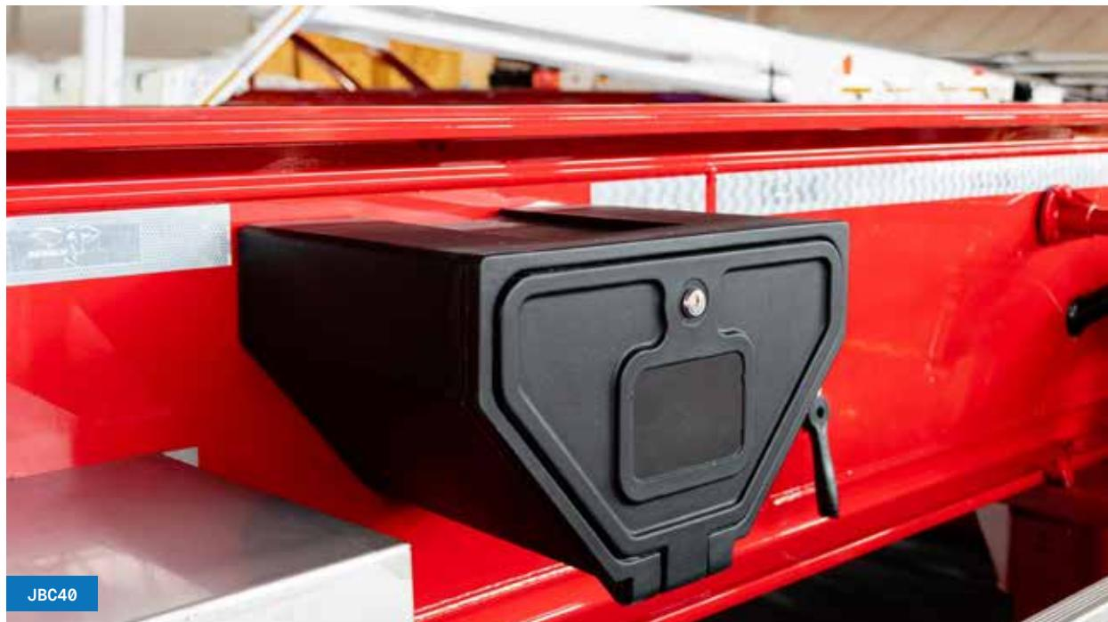
Plus petits et compacts que les coffres à outils Jonesco, nos coffres de rangement verrouillables sont tout aussi sécurisés. Disponibles en deux modèles (à serrure ou à cadenas), ils sont dotés d'un joint étanche qui prévient toute infiltration d'eau et d'un couvercle à charnière avec ouverture à 180° pour faciliter l'accès au contenu. Si leur forme permet de les placer facilement entre les passages de roue, ils s'adaptent à tous les espaces.
