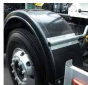
la travée du garde-boue en l'étirant légèrement sur les fixations. La réduction de la travée est en revanche déconseillée.
