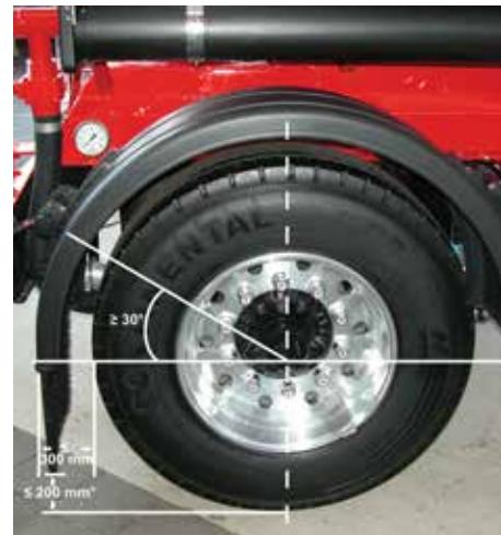
\* $\leq 300 \text{ mm}$  sur le dernier essieu si  $Rv \leq R$  ou en fonction des caractéristiques de la suspension
