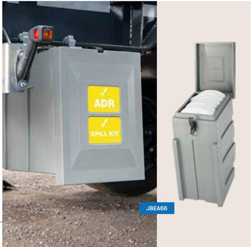
Der 66er ADR Topladerkasten ist für die sichere Aufbewahrung von Sicherheitsausrüstung bestimmt, z. B. Leckage-Sets, und ist ideal für Fahrzeuge geeignet.
