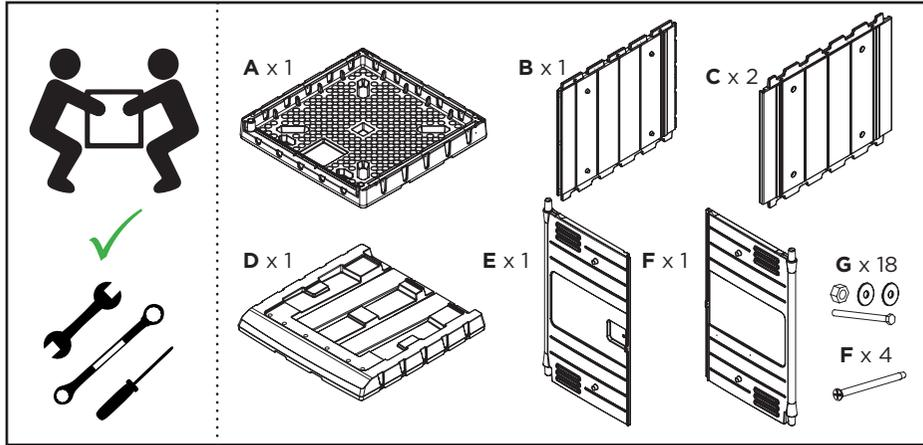
1. Coloque **A** sobre una superficie plana      2. Inserte **B** en la parte posterior de **A**
