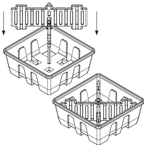
9. Coloque la cubierta dura para GRG en los soportes centrales del palé antiderrames utilizando las cavidades de la carretilla, asegurándose de que la plataforma esté alineada con los soportes centrale
