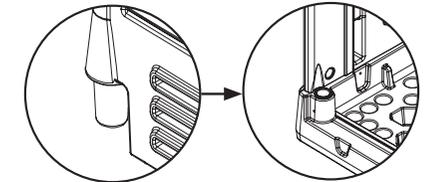
Levante **D** a la vista para que **E** encaje en la parte superior
