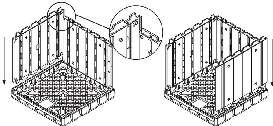
4. Coloque **D** sobre **B** y **C** asegurándose de que **B** y **C** encajan en **D**      5. Inserte **E** en **A** y **D**
